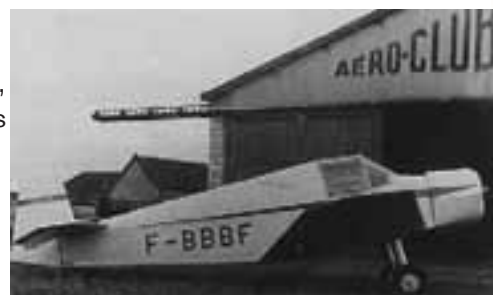
Prototype du D11, l'une des versions phares de la gamme Jodel. Cet exemplaire est motorisé par un Salmson en étoile de 45 ch.
