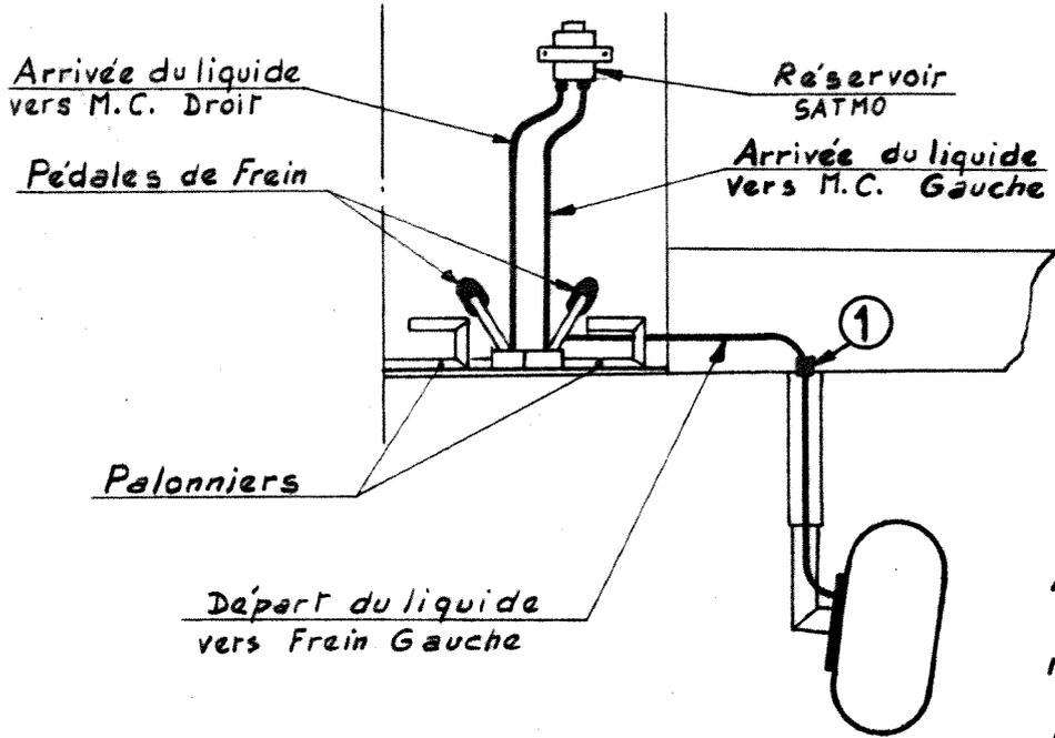
Pour démontage Aile et Fuselage débrancher Raccord rep. ① et Raccord rep. ② sur M.C. et enlever tuyauterie ③
